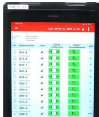
The results of an automatic brake test on a handheld device. Резултатите от тест на автоматична спиратка на ръчно устройство.
